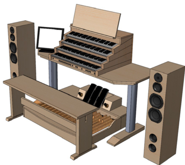
Klavierblok C Hauptwerk IV klaviers met 17" monitor en set exclusieve Mixtuur 3-weg luidsprekers met dubbele bas
